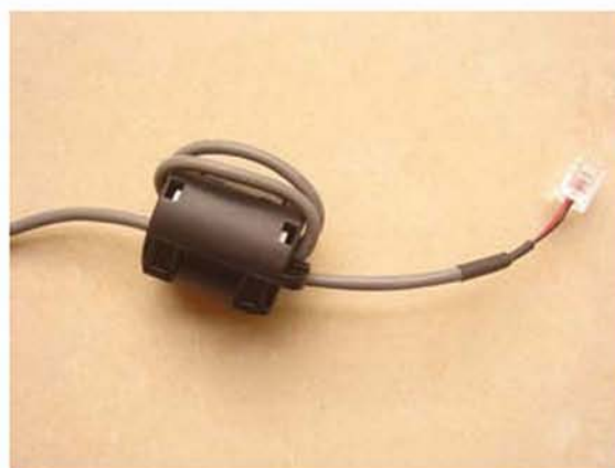
Fot. 2 Umieszczenie pierścienia magnetycznego względem wtyczki typu telefonicznego
