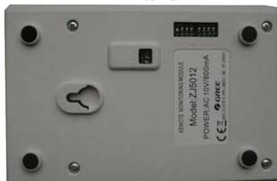
Przełączniki DIP z tyłu modułu komunikacyjnego
