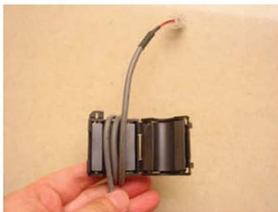
Fot. 1 Sposób montażu wtyczki, kabla komunikacyjnego i pierścienia magnetycznego
