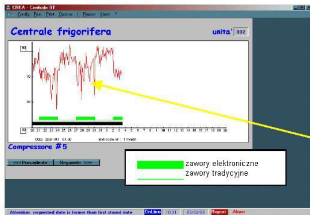
Il. 16: temperatura na tłoczeniu sprężarki w niskotemperaturowy układzie chłodniczym w okresie od 20 stycznia – 3 lutego 2003.
