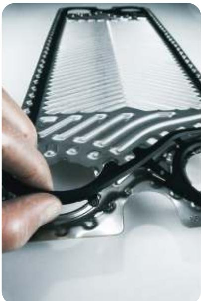
Одним из главных аргументов использования ПТО вместо ППТО является то, что ПТО можно разобрать и тщательно очистить. Однако процесс химической очистки ПТО может быть очень дорогим. Перед очисткой прокладки должны быть сняты, а если они приклеены к пластинам (как в случае со многими видами прокладок), после очистки их необходимо заменить дорогостоящими новыми прокладками.
