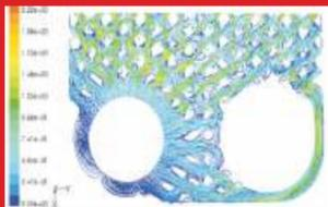
Моделирование – один из важнейших инструментов для разработки новых и совершенствования существующих ППТО. Оценка различных видов пластин с помощью моделирования расходов и направлений позволяет улучшать рабочие параметры теплообменников.
